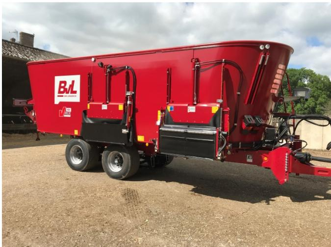
La mélangeuse BvL V-MIX Plus 33-3S est équipée de trois vis de mélange et convient à l'alimentation des grands troupeaux.
