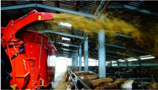
Avec la pailleuse V-COMFORT Turbo de BvL, directement intégrer dans les mélangeuses de fourrage, un paillage puissant avec une portée jusqu'à 25m.
