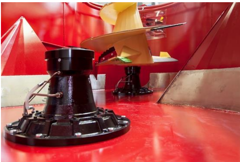
Légende 5 : Les vis mélangeuses, « pièces maîtresses » des mélangeuses de fourrage, sont installées avec précaution lors du montage final.
