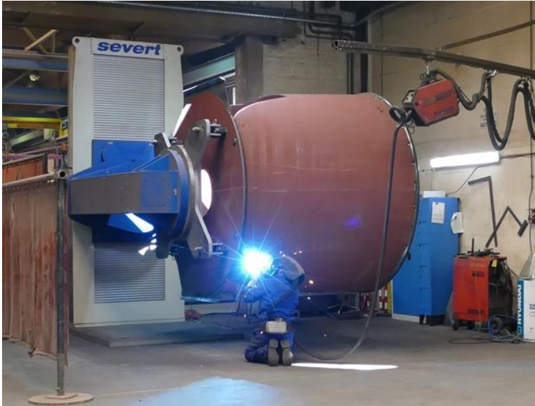
Légende 4 : Un soutien moderne à l'artisanat - Une précision absolue est de mise pour la production des cuves de mélange
