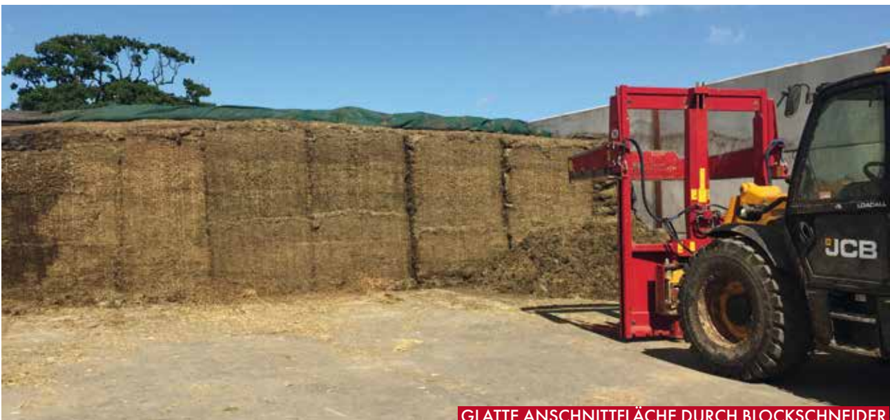
GLATTE ANSCHNITTFLÄCHE DURCH BLOCKSCHNEIDER
