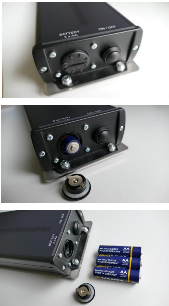
Abb. 4-2: Batteriewechsel beim V-CONNECT Cut Control
