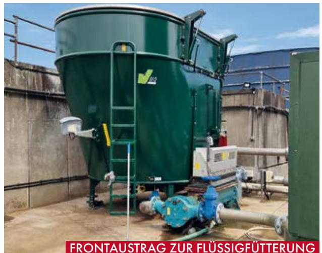
HYDRAULISCH BETRIEBENER FRONTAUSSTRAG
