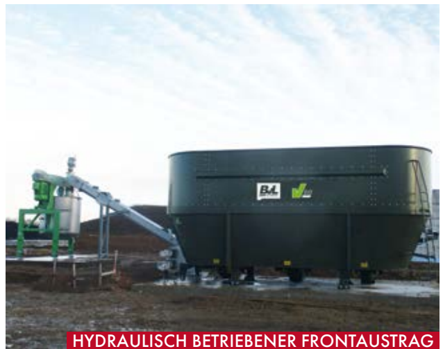
SCHNECKENFÖRDERSTRANG ZUM BEFÜLLEN DES ERDFERMENERS
