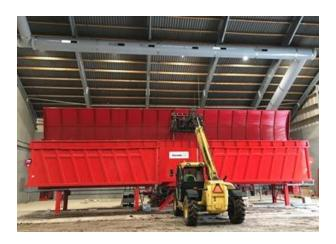
Dans le cadre d'un récent projet, un dosificateur de matières solides BvL d'un volume de 100 m³ a été installé pour un exploitant d'installations de biogaz danois, conjointement avec l'entreprise Vogelsang.
